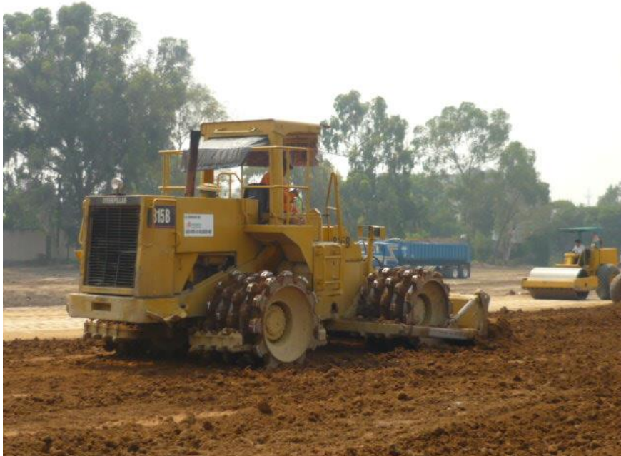
FOTOGRAFÍA 20.- EL RODILLO "PATA DE CABRA" ES RECOMENDADO PARA LA COMPACTACIÓN DE SUELOS CON IMPORTANTE PORCENTAJE DE SUELOS FINOS, ARCILLAS Y LIMOS. LA VENTAJA DE ESTE EQUIPO ES QUE A LA VEZ QUE TIENDE LA CAPA POR COMPACTAR Y COMPACTA DURANTE EL TENDIDO. LA MARCA CATERPILLAR TIENE LOS MODELOS 815 B, 815 F Y 825 K, CUYOS PESOS SON MAYORES A LOS 200 KN.
